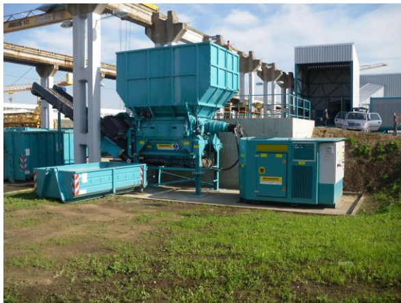
Bild 4 und 5: Aufstellungssituation und Beschickung der Zerkleinerungsanlage
