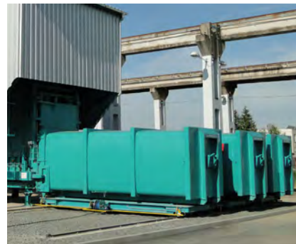
Umladepresse MP 3000 TS und Verschiebewagen für drei Pressbehälter
