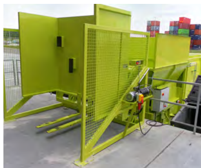
Stationäre Hub-Kippvorrichtung für Paletten
