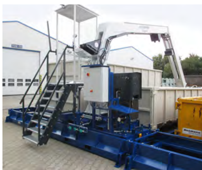
Auf Schienensystem verschiebbarer Walzenverdichter GT-T 1750
