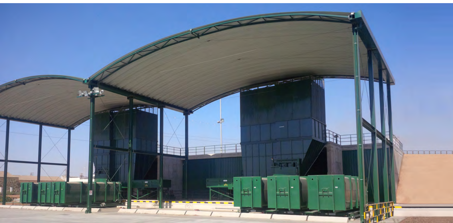
Umladepresse MP 6070 TS im Parallelbetrieb mit Rollenbahn für Container
