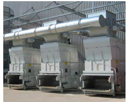
Kurzbaupresse ST-SEL mit Trichter für Abscheider
