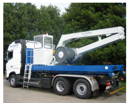
Mit Hakenlift auf LKW aufgezogener Walzenverdichter GT-TM 1750
