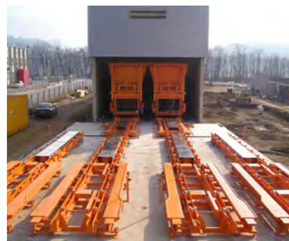
Umladepresse MP 6070 TS im Parallelbetrieb mit Rollenbahn für Container
