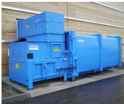
Kurzbaupresse ST-SEN mit Wandanschlussstrichter
