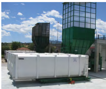
Umladepresse MP 6070 TS mit Windschutz oberhalb des Einfülltrichters
