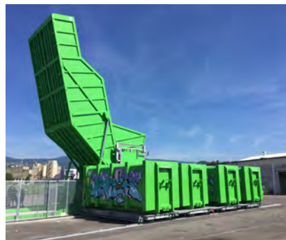
Ladeschaufel an Reststoffpresse montiert, mit 4 Pressbehältern auf Verschiebewagen
