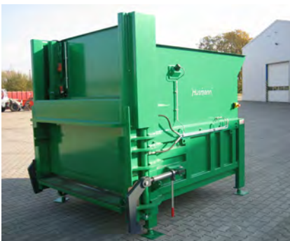
Kurzbaupresse ST-SEL mit Vorpressschild
