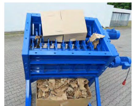
Pappzerreißer (Sicherheitsvorrichtung nicht abgebildet)
